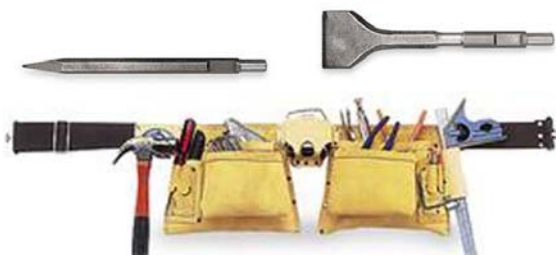
Figura 3. Punta de cincel para martillo de impacto, y un bolso de cintura para herramientas.
